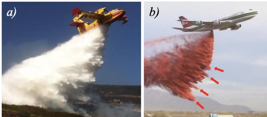
Figure 1: Largage (a) d'eau par un Canadair CL415 et (b) d'un produit retardant par un Boeing 747. Une instabilité se développe sur le front de la colonne de liquide.
