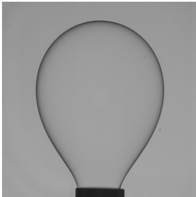
Figure 4.1: Image d'une goutte heptane attachée à un tube capillaire dans l'eau, \sigma \approx 40 \left[ \frac{mN}{m} \right] . ( Rapport de Master, G.J. Oosterbaan, IMFT )
